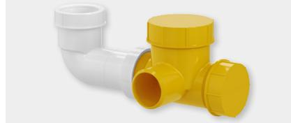
Siphon à bille pour conduite de condensats. Obligatoire si les condensats sont évacués dans le collecteur domestique des eaux usées ou vers l'intérieur du bâtiment.
